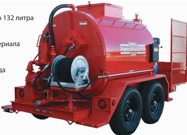
Опциональный распылитель установки Super Sealcoater CRAFCO разработан для проектов выполнения дорожных покрытий большой шириной, что позволяет эффективно применять установку для зон парковки и широких пешеходных зон. Он быстро устанавливается и не требует дополнительного уплотнения.
